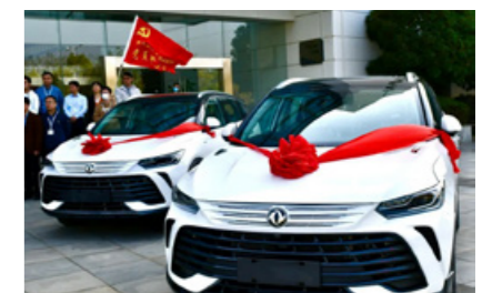
● 国内首款全功率燃料电池乘用车“东风氢舟”百公里耗氢量仅为0.751公斤，达到国际领先水平
