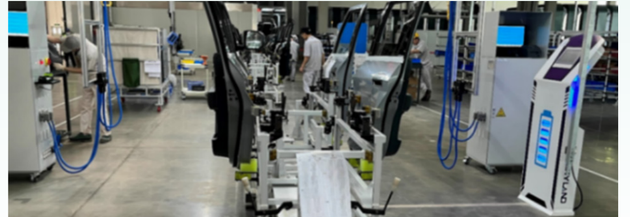
• AGV车门输送链
