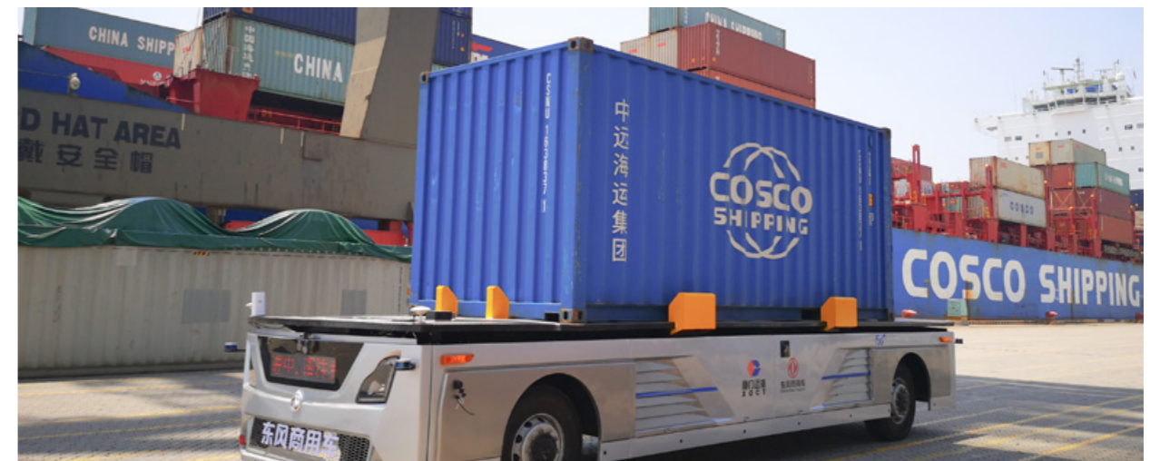
• 东风公司自主开发的第三代无人集卡在厦门投入实船使用
